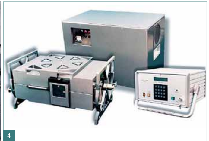
Obr. 6 Uranový kryt TECH/OPS pro zářič Co 60 o aktivitě 1 TBq ■ Fig. 6 Uranium shielding TECH/OPS for a gamma source Co 60 of activity of 1 TBq
