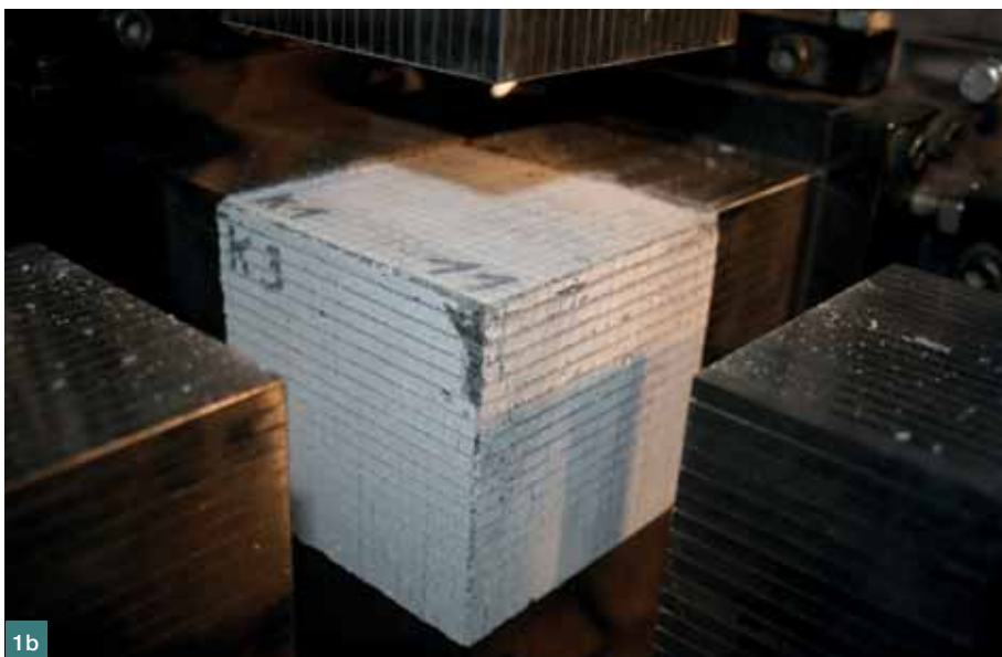
Obr. 3 Historie napětí, a) v triaxiální komoře, b) v triaxiálním lisu ■ Fig. 3 Stress path a) in triaxial chamber, b) in multiaxial testing machine
