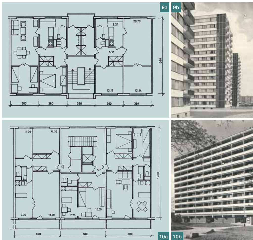
Obr. 9 a) Typické podlaží řadové sekce typu T06B, b) bytové domy typu T06B v Praze-Malešicích (zdroj: [9]) Fig. 9 a) Typical floor of row section T06B, b) apartment houses type T06B in Prague -Malešice (source: [9])
